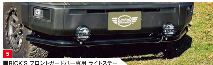
5 ■RICK'S フロントガードバー専用 ライトステー フロントガードバー用のライトステー(加工無)ガードバーヘライトを装着したい方は便利です。 スチール製カチオン電着の4mm厚なのでプレも軽減。
